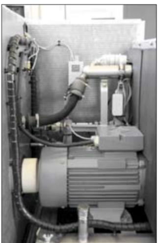
Blick ins Innere: Unter der wirkungsvollen Schallschutz- und Wärmedämmung verbergen sich Serienteile oder serienfähige Komponenten, die den preiswerten Aufbau ermöglichen. Hier der Generator.
